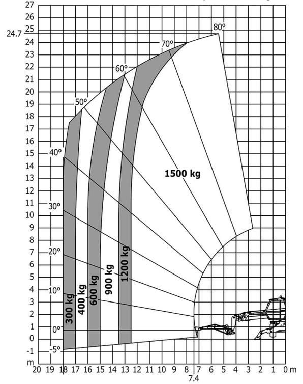
Machine sur stabilisateurs abaissés avec nacelle 365 kg
