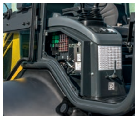
Capot latéral facilitant l'accès lors de la maintenance et du nettoyage intérieur
