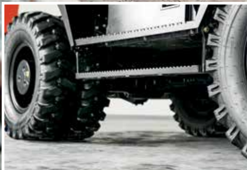
La garde au sol importante réduit les dommages dus aux obstacles.
