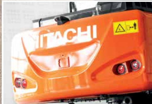
Les feux arrière à LED sont faciles à entretenir.
