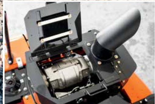
Le système SCR permet de réduire les émissions et les niveaux de bruit.
